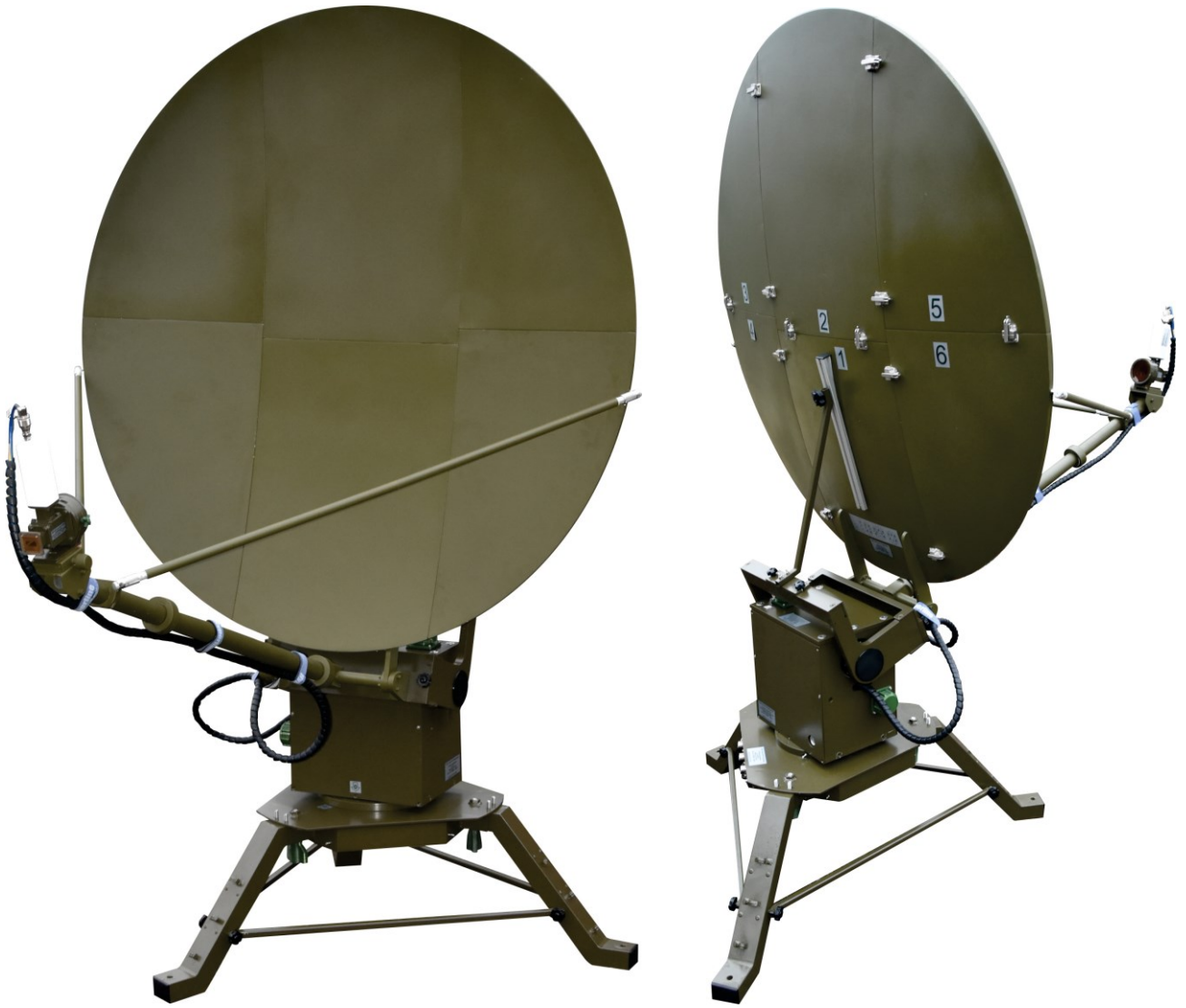
Рисунок 3 – Внешний вид СССТ 1,2 м в развернутом состоянии
