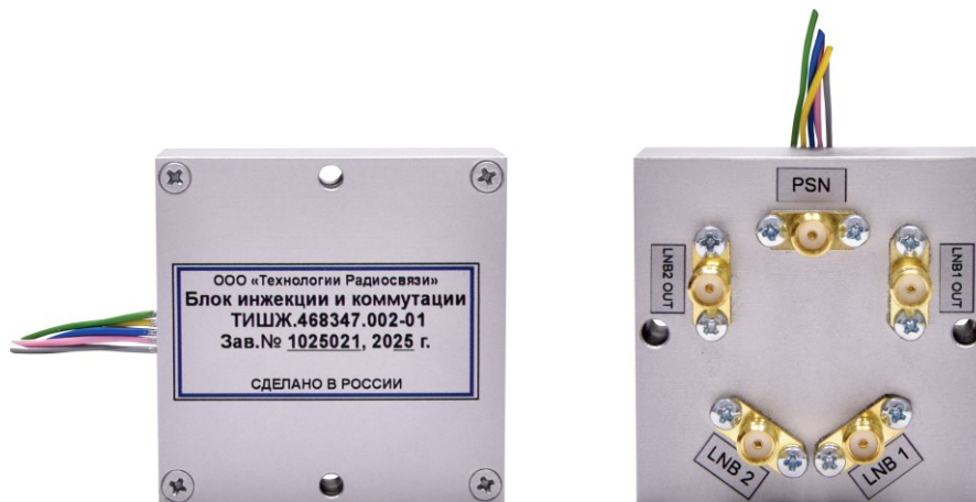
Рисунок 9 – Блок инъекции и коммутации ТИШЖ.468347.002-01 Основные технические данные приведены в таблице 5.
