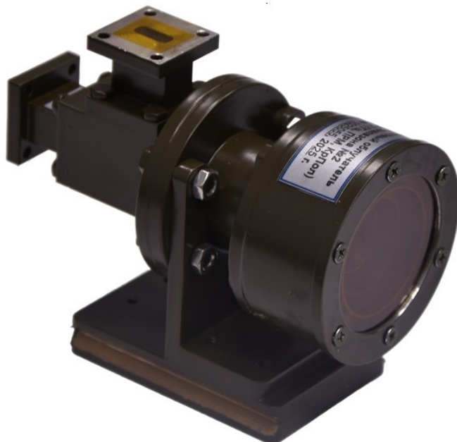
Рисунок 14 - Внешний вид двухпортового облучателя Ка-диапазона №2 (17,70 -20,20) ГГц с круговой поляризацией
