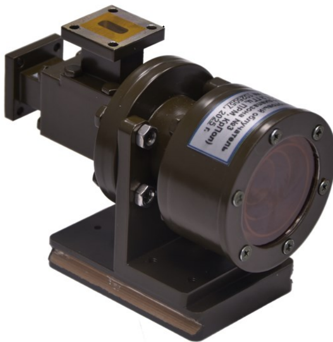
Рисунок 15 - Внешний вид двухпортового облучателя Ка-диапазона №3 (20,20 -21,20) ГГц с круговой поляризацией
