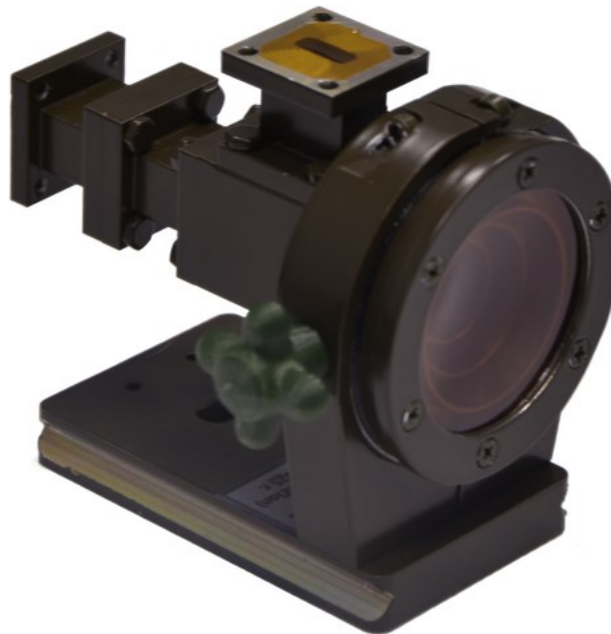
Рисунок 13 - Внешний вид двухпортового облучателя Ка-диапазона №1 (17,70 -20,20) ГГц с линейной поляризацией
